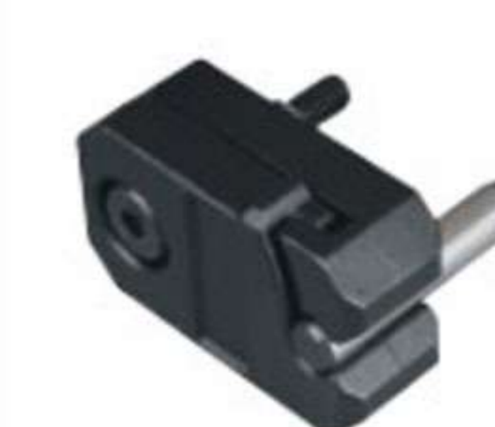
PSM D11 限位夾 SLIDE RETAINER M 材質 合金鋼8620steel H 硬度 HRC58°~62°
