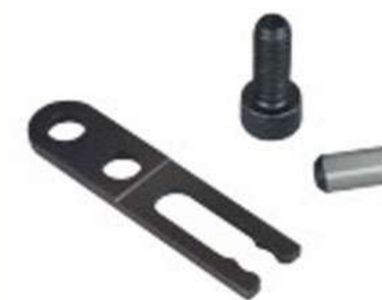
RRM D15 限位夾 SLIDE RETAINER M 材質 1.8159 H 硬度 HRC45°±3°
