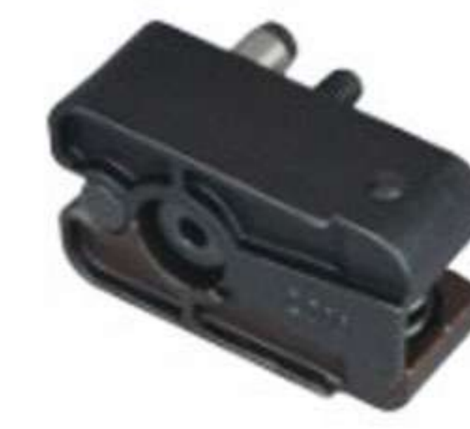
MRT D12 限位夾 SLIDE RETAINER M 材質 合金鋼8620steel H 硬度 HRC58°~62°
